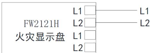
FW125 按如下接线，接在兼容的控制器回路线上，无极性要求。
