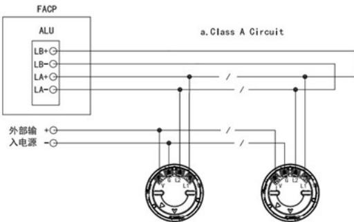
图 3 SLC 回路 Class A 接线 (FW2962 忽略外部电源)
